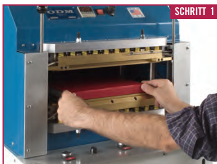
Die Bedienperson legt das gebundene Buch in den Smasher und betätigt das Fusspedal, um die genaue Falzposition zu finden
