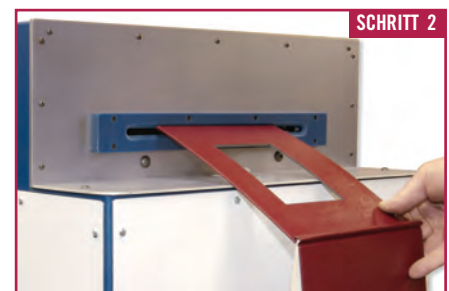
SCHRITT 2 Drücken des Fußschalters löst den Stanzvorgang aus
